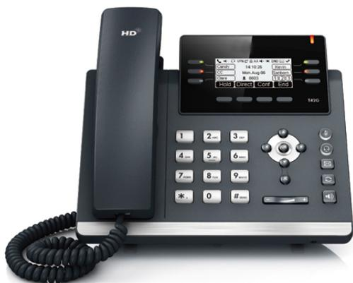
SIP терминал **T42G** отличается от модели **T41P** наличием USB-разъёма для подключения беспроводной гарнитуры и содержит два Gigabit порта RJ-45 (режим Bridge).
